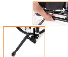
090008/090033 Sicherheitsrad abschweng- und vom Nutzer bedienbar
